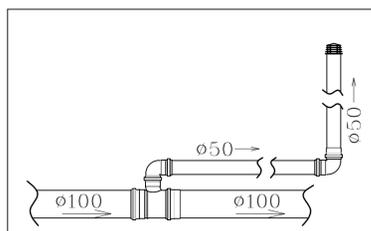
Detalhe Coluna de Ventilação SEM ESCALA
