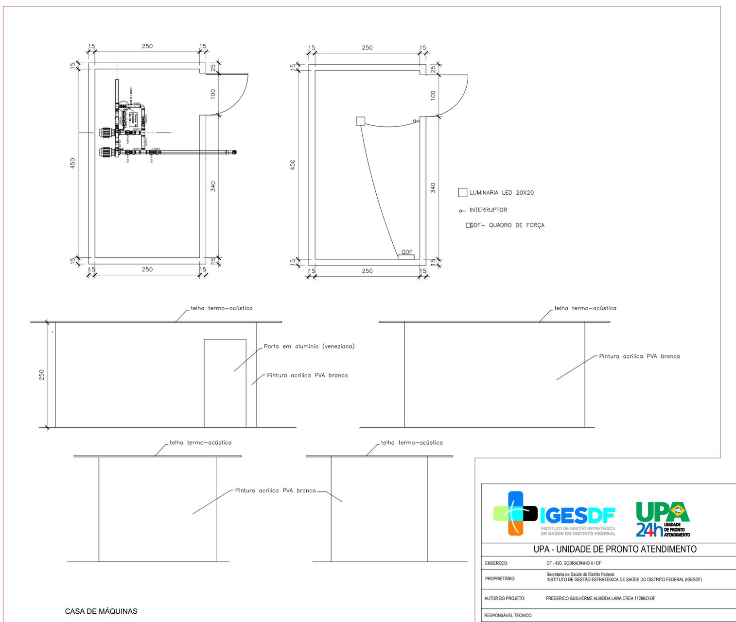
\*O CONJUNTO DE BOMBAS DEVERÁ SER INSTALADO AO LADO DO RESERVATÓRIO, NA CASA DE MÁQUINAS
