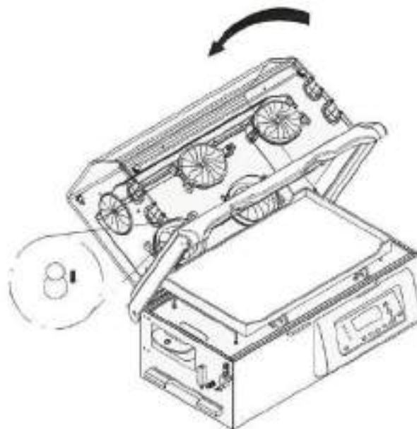
Figura 248 - Retirando cúpula interna – incubadora com corpo metálico
