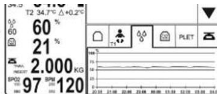
Figura 161 – Display – controle de umidificação incubadora com módulo MC3
